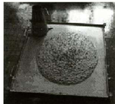
Figure 2 : Exemple d'étalement d'un BAP.
